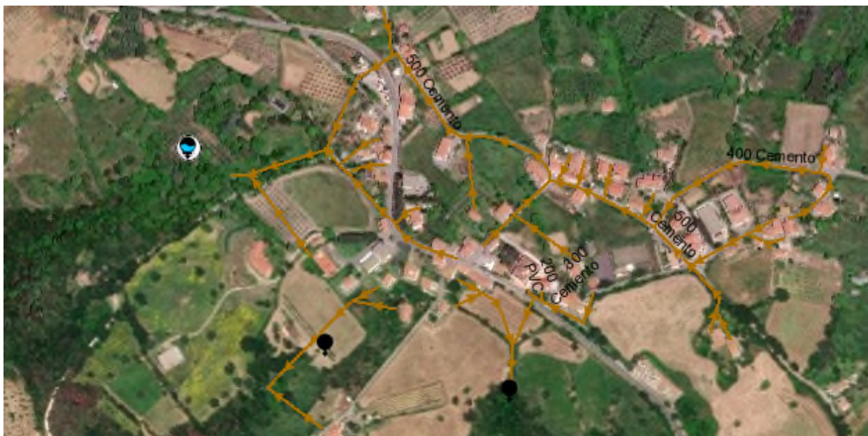
Figura 1: Rete fognaria della Frazione Pancole
