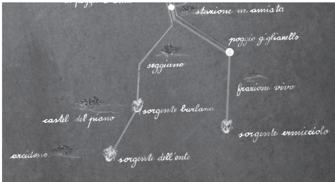
Particolare delle nuove condotte, che dirigono le acque delle sorgenti Ente e Burlano vicine ai paesi di Arcidosso e Casteldelpiano, verso Seggiano e la Stazione Monte Amiata dove correranno parallele alla linea proveniente dalla sorgente Ermicciole.
