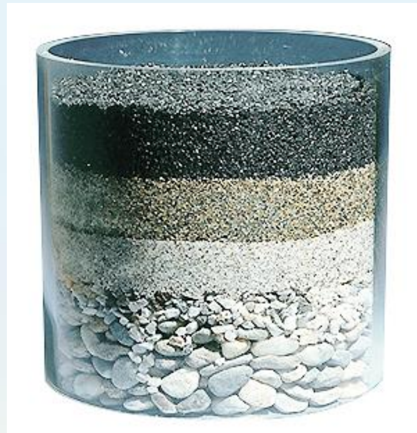
Strati di minerali utilizzati per la filtrazione
