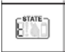
Il simbolo indica che il contatore è in modalità test e si spegne non appena la verifica è terminata. Si presenta solo al momento dell'installazione del contatore.
