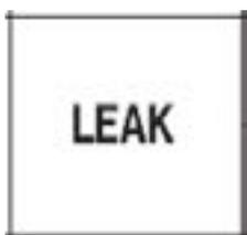
Si accende quando per 24 ore consecutive (senza interruzioni) il misuratore rileva un flusso continuo. L'indicatore di perdita viene ripristinato quando il flusso torna nella norma in base alla media rilevata storicamente.
