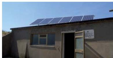
1. **Poggio dei Colombi** => impianto fotovoltaico "in isola" avente potenza di picco 4,4 kWp;
