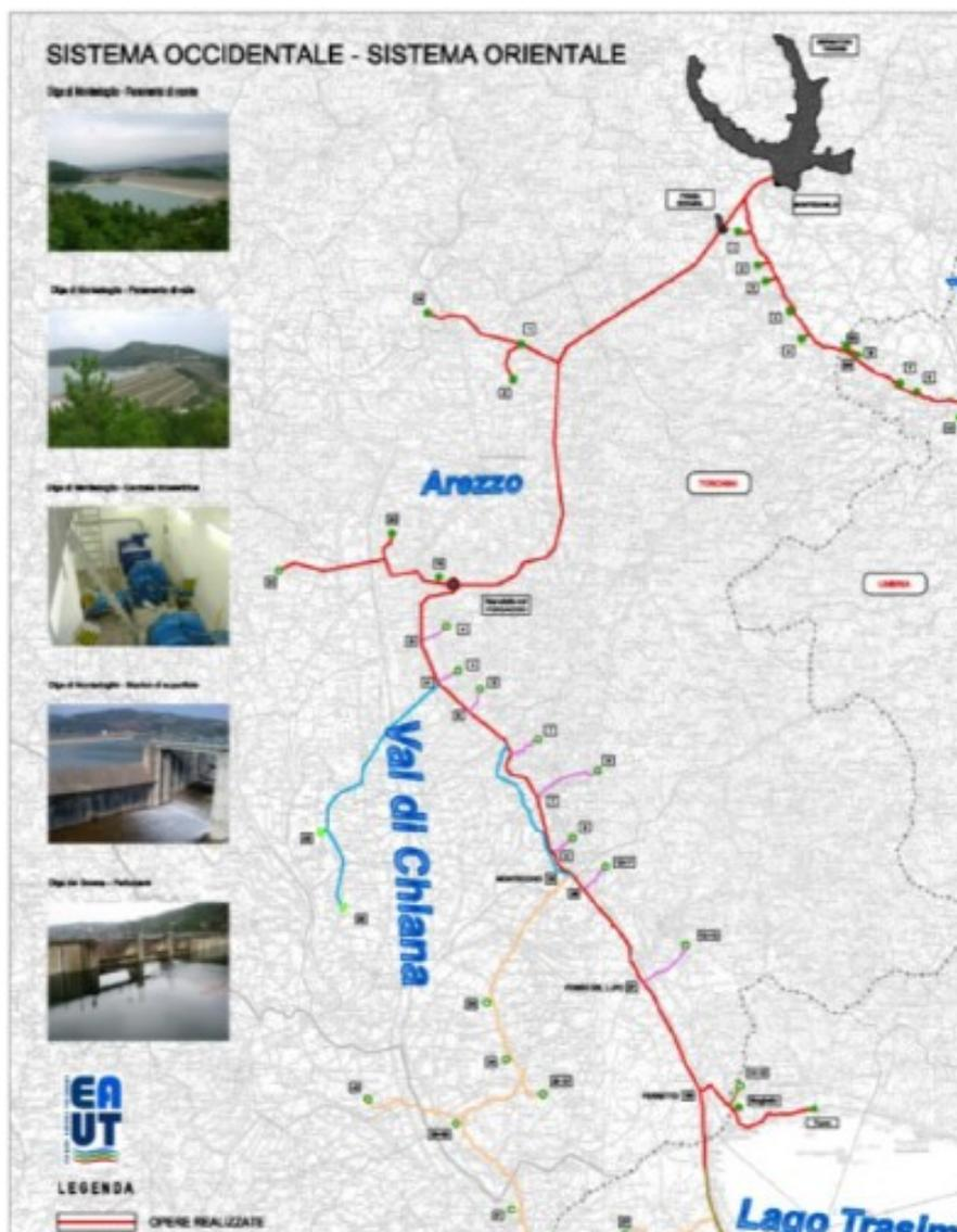
Figura 2. Schema della rete irrigua proveniente dall'invaso di Montedoglio e gestita dall'Ente Acque Umbro-Toscane
