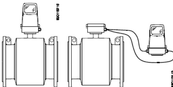
Il collegamento tra sensore e convertitore nella versione separata può essere eseguito con cavi standard e non aventi caratteristiche specifiche dettate dal costruttore. La lunghezza dei cavi, in funzione della conducibilità del liquido, deve poter coprire distanze fino a 300 m.
